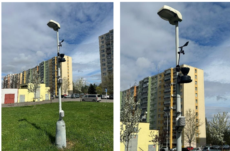
Obr. 22 Chybné umístění srážkoměru na výzkumném bodě 231 – lampa přímo brání srážkám
