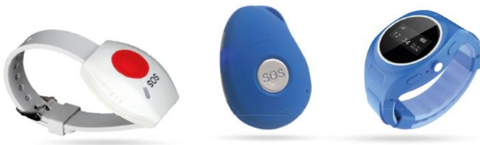
Obrázek 2 – Klientská zařízení použitá v projektu. Vlevo – náramek ke stacionární jednotce pro domácí použití (Život 90). Vpravo – hodinky na ruku (Chytrá péče). Uprostřed – přívěšek na krk (vajíčko) použité oběma provozovateli.
