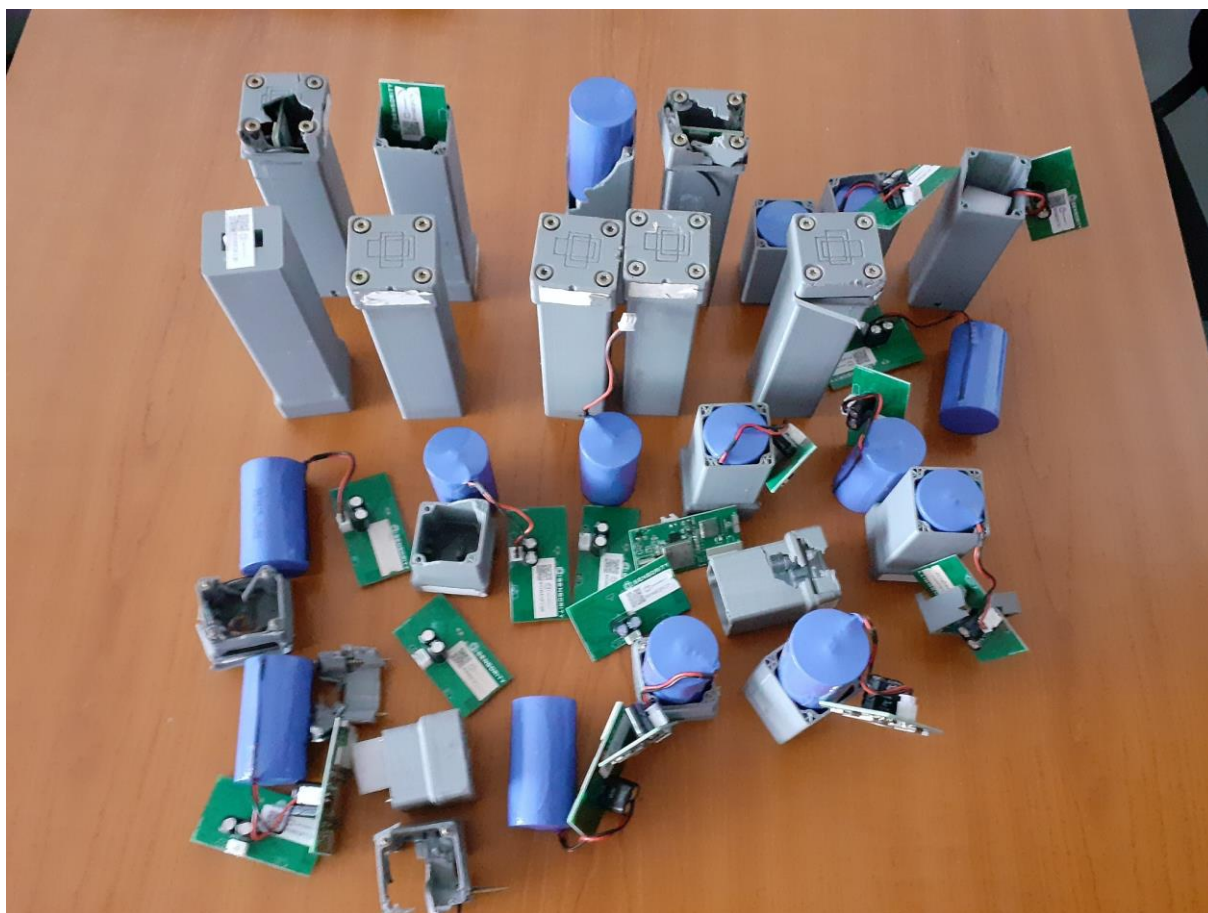
obr. 1 - Senzory s poškozeným plastovým obalem
